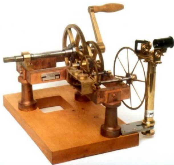
Oldenburger Nachbau von Fizeaus Apparatur
